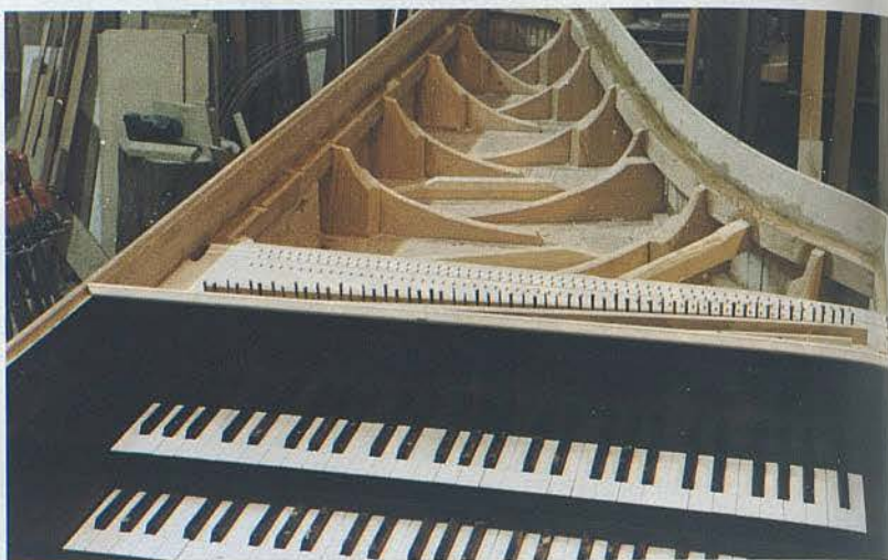
Sistema d'escaires, semblant a una barca. Instrument alemany del segle XVII que usa el sistema d'escaires italià. Construït per Joan Martí segons model de Christian Zell
