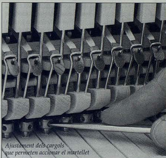
Amb unes alicates especials, s'ajusta el joc lateral movent el pern de la barra central
